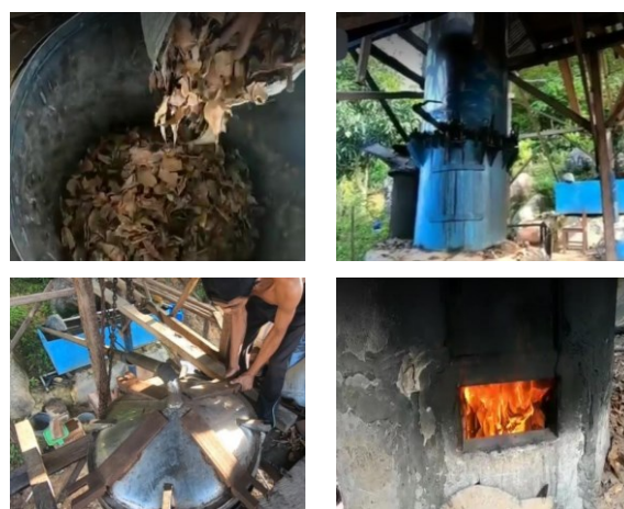
Gambar 2. Proses pembuatan minyak atsiri berbasis limbah perkebunan daun cengkeh dan daging buah pala
