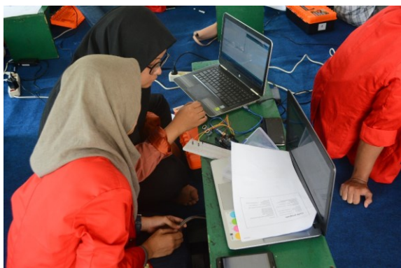
Gambar 3: Peserta menanamkan kode program ke dalam Arduino Uno untuk membuat alat pengukur jarak menggunakan sensor ultrasonik..
